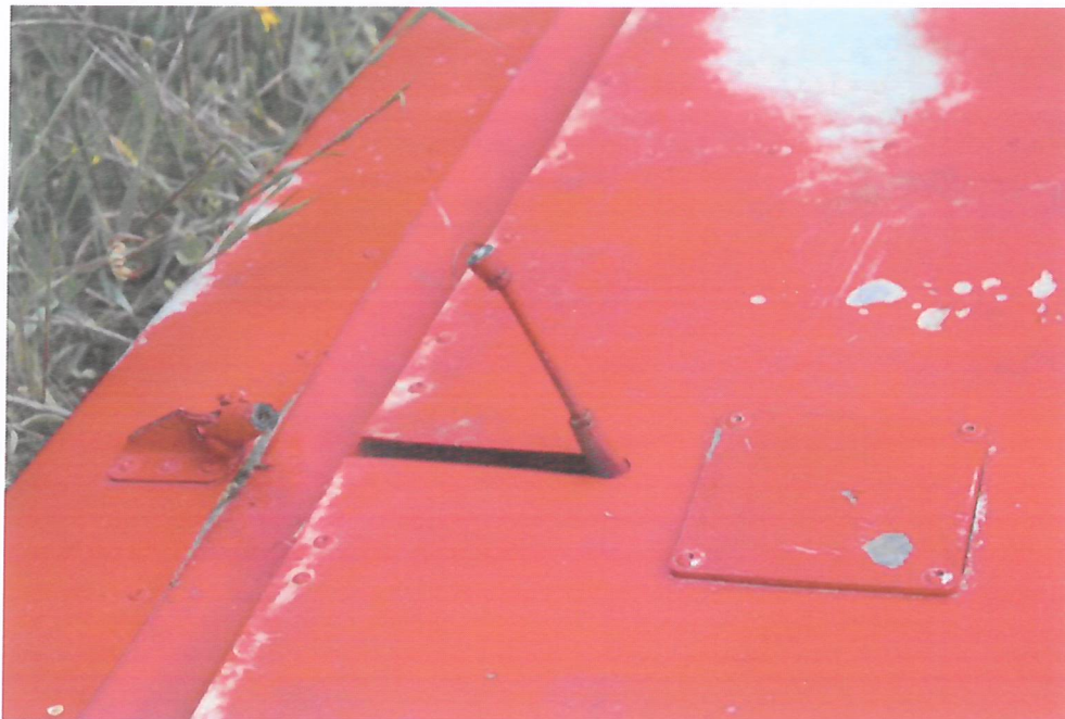
Φωτ. 12: Συνδεσμολογία του "Trim Tab Elevator"
