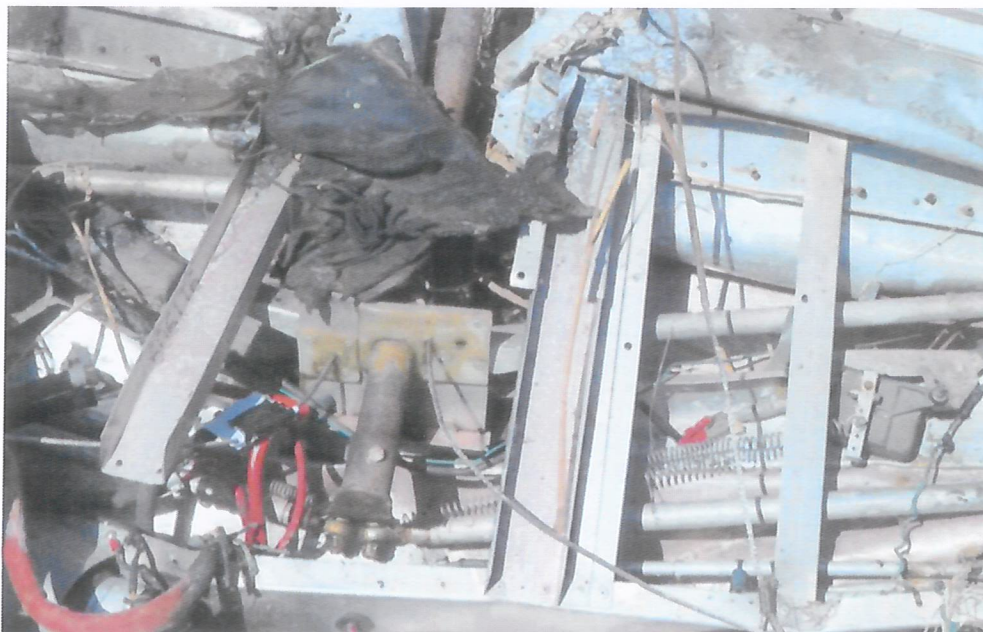
Φωτ. 13: Συνδεσμολογία των "Ailerons"
