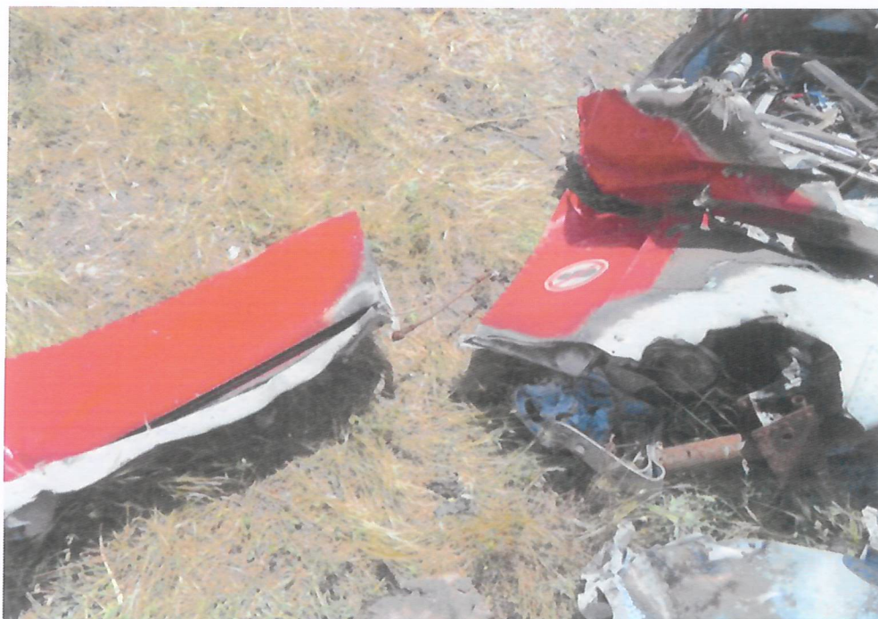
Φωτ.17: Δεξιό "Aileron" και "Flap"
