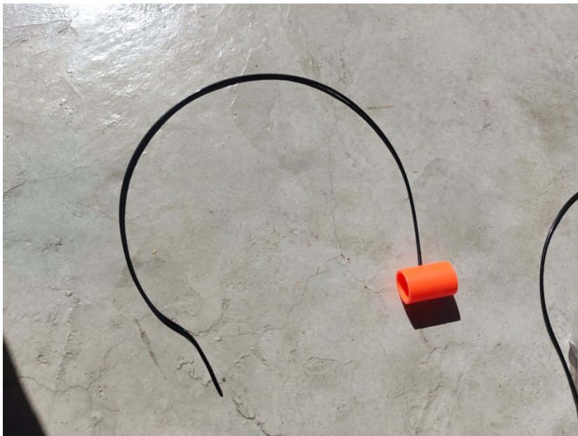
Η ΛΑΒΗ ΕΝΕΡΓΟΠΟΙΗΣΗΣ ΤΟΥ PILOT CHUTE ΠΟΥ ΠΑΡΑΜΕΝΕΙ ΣΤΟ ΧΕΡΙ ΤΟΥ ΑΛΕΞΙΠΤΩΤΙΣΤΗ
