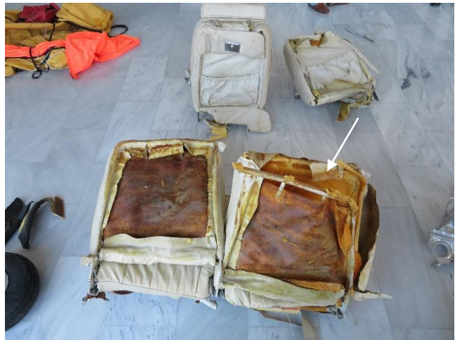
Φωτ. 22: Το πλαίσιο της πλάτης του οπίσθιου καθίσματος όπου διακρίνεται η θραύση και παραμόρφωση του πλαισίου της δεξιάς πλάτης προς τα αριστερά.
