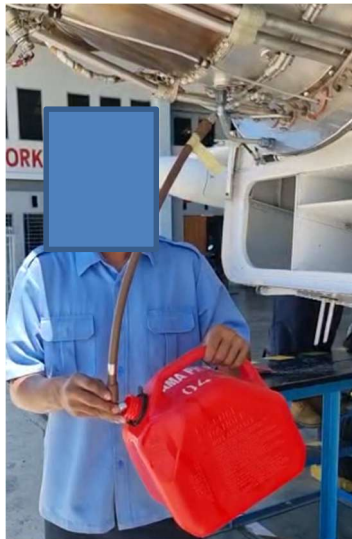
Εικόνα 21: Δοκιμή για τον καθορισμό της ποσότητας καυσίμου μετά την έξοδο από την βαλβίδα διακοπής σε κλειστή θέση
