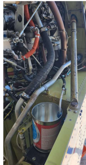
Εικόνα 22: Συλλογή της ποσότητας καυσίμου κατά την διάρκεια της δοκιμής
