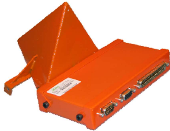
Εικόνα 13: Αποθήκευση οργάνων σε κάρτα μνήμης σε μονάδα στο ουραίο τμήμα του α/φους
