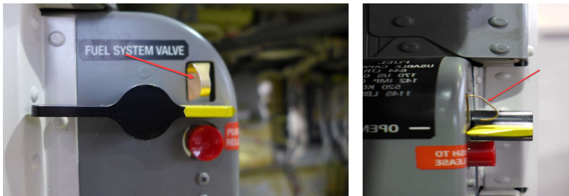
Εικόνα 7: Διακόπτης Χειρισμού Βαλβίδας Διακοπής Καυσίμου
