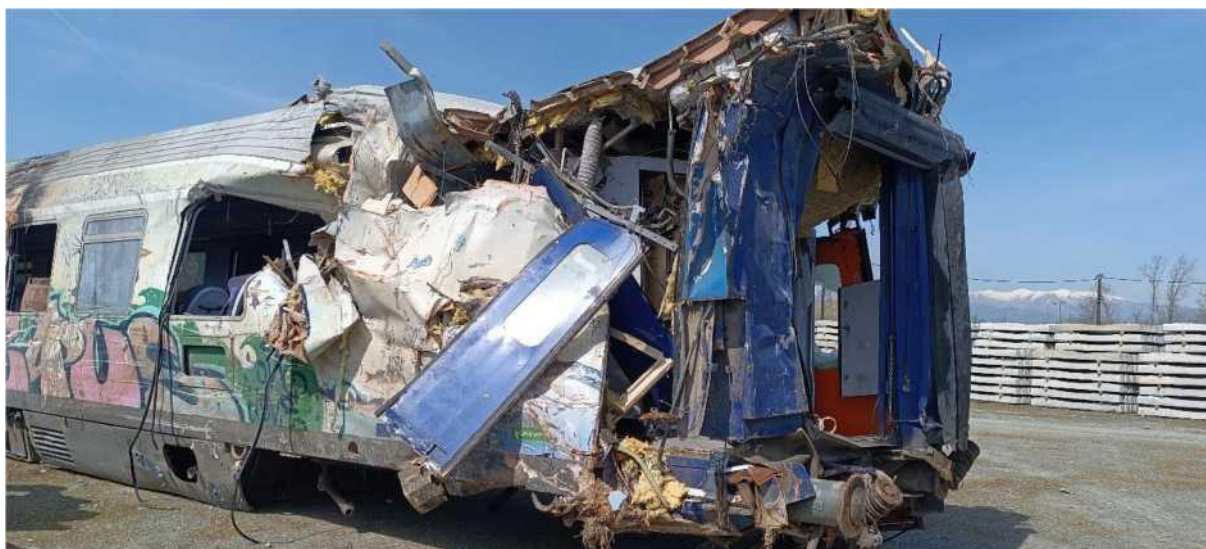
Εικόνα 88. Θέση 5) Β3 βαγόνι 2ης θέσης, εκτροχιάστηκε και κατέθηκε στην πλαγιά, έχασε τα φορεία, καμία άλλη ζημιά από εκτροχιασμό ή σύγκρουση, ειδική ζημιά πρόσκρουσης στο Β2 το οποίο έπεσε από επάνω.
