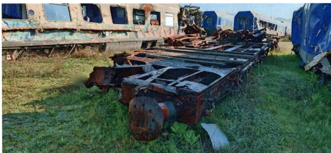
Εικόνα 79. Θέση 3) αρ. 1 πλατφόρμα που φέρει χαλύβδινες πλάκες, το μπροστινό μισό έχει καταστραφεί ολοσχερώς από ισχυρή πρόσκρουση με το βαγόνι εστιατορίου.
