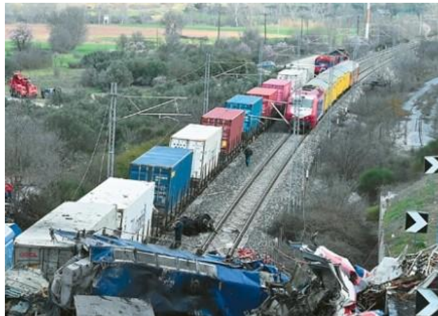
Εικόνα 84. Θέσεις 8)-15) Οι υπόλοιπες πλατφόρμες που φέρουν 8 κοντέινερ, άθικτα και ακόμη σφραγισμένα (ή παρέμειναν κενά, τα 2 τελευταία), δεν εκτροχιάστηκαν, σταμάτησαν κατά μήκος της γραμμής και απομακρύνθηκαν κανονικά.
