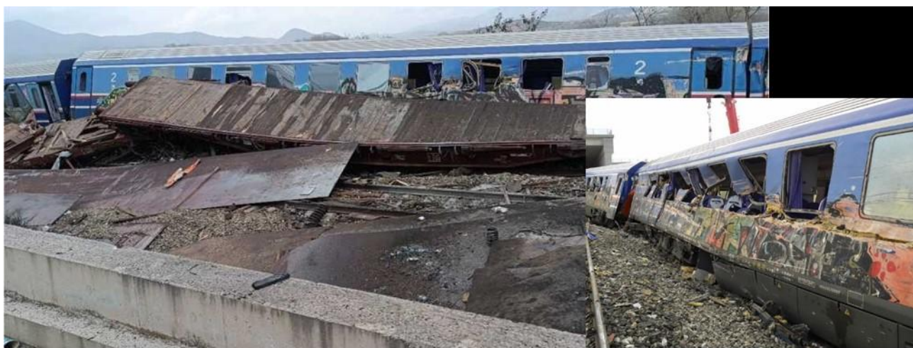
Εικόνα 25. Γραμμική σύγκρουση χαλύβδινων ελασμάτων στις πλευρές του βαγονιού B4.
