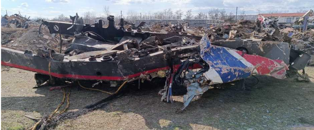
Εικόνα 17. Τμήμα (σασί) της ολοσχερώς κατεστραμμένης ηλεκτράμαξας 120-023 της επιβατικής αμαξοστοιχίας IC-62.
