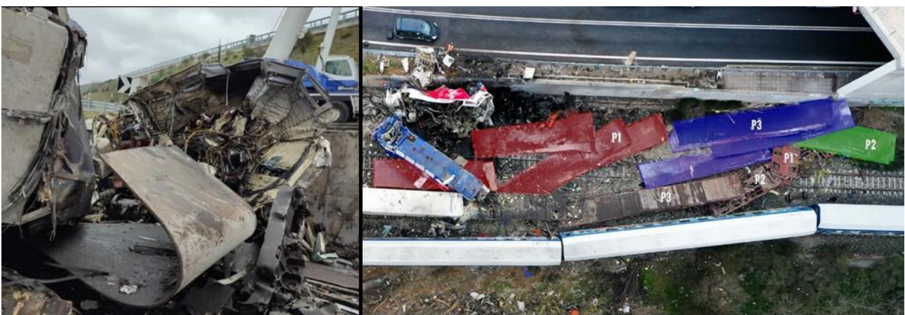
Εικόνα 22. Υπολείμματα των επάνω χαλύβδινων ελασμάτων και τελική θέση των 3 σετ χαλύβδινων ελασμάτων.
