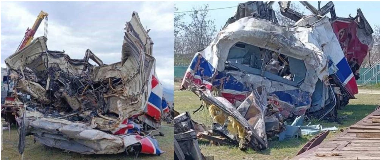
Εικόνα 77. Θέση 1) Siemens Hellas Sprinter 120-022- NVR Engine: 91 73 212 0 022-7 Σοβαρές ζημιές στο μπροστινό μέρος, η οροφή που λείπει και το πίσω μέρος έχουν υποστεί μεγάλες ζημιές από την πίσω σύγκρουση με την προσαρτημένη ηλεκτράμαξα 120-012. Πίσω όψη στο σχήμα Εικόνα 14.
