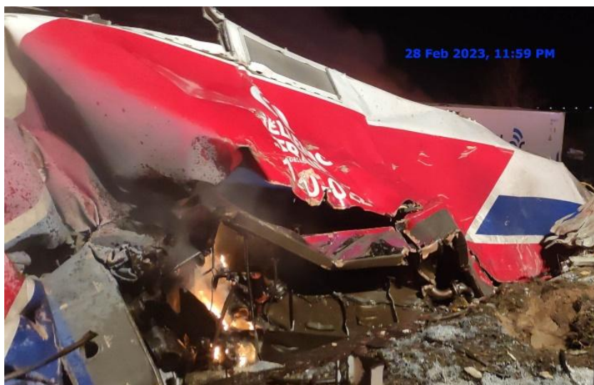
Εικόνα 65. Τοπική πυρκαγιά μέσα και έξω από τον σπασμένο μετασχηματιστή της πρώτης ηλεκτράμαξας της εμπορευματικής αμαξοστοιχίας, 40 λεπτά μετά την ατύχημα.
