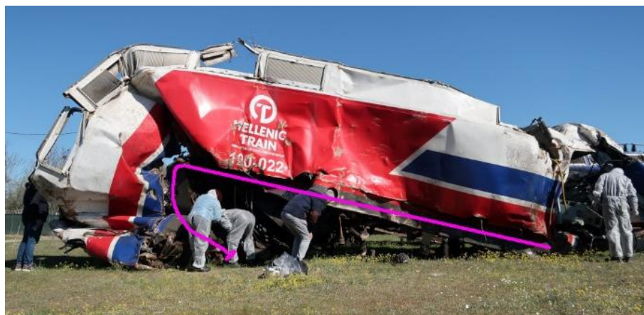
Εικόνα 14. Η πρώτη ηλεκτράμαξα του εμπορικού (120-022) με εκτεταμένες ζημιές από την πολύ ισχυρή μετωπική σύγκρουση με την ηλεκτράμαξα του επιβατικού συρμού (120-023).
