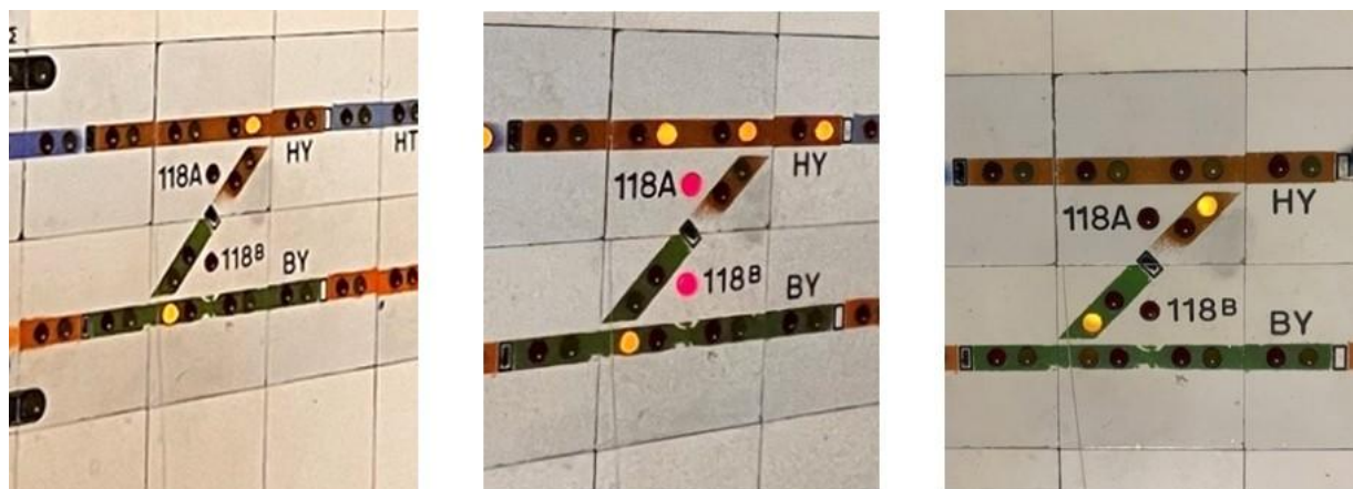
Εικόνα 47. Λεπτομέρεια των αλλαγών 118 στον Πίνακα Ελέγχου Λάρισας (κύρια - κινούμενη - παράκαμψη).
