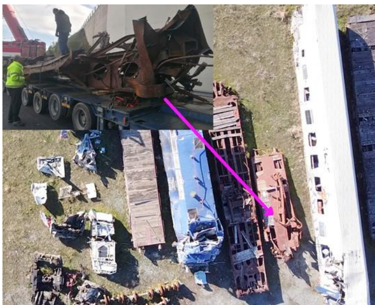
Εικόνα 19. Υπολείμματα της πρώτης πλατφόρμας, η οποία μετέφερε μεταλλικά ελάσματα.
