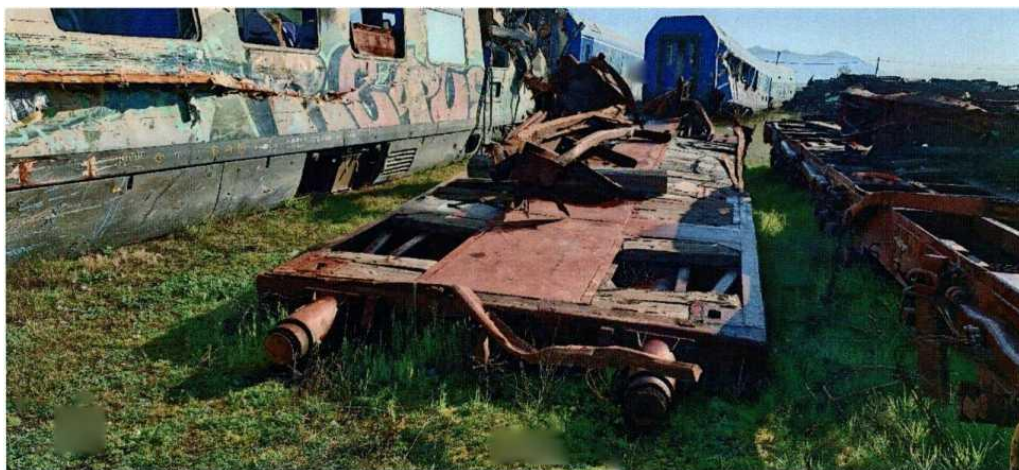
Εικόνα 80. Θέση 4) πλατφόρμα no 2 που φέρει χαλύβδινες πλάκες, με χαμένα τα φορεία από τον εκτροχιασμό αλλά πολύ ελαφρά κατεστραμμένα, χωρίς σημάδια βαριάς σύγκρουσης.
