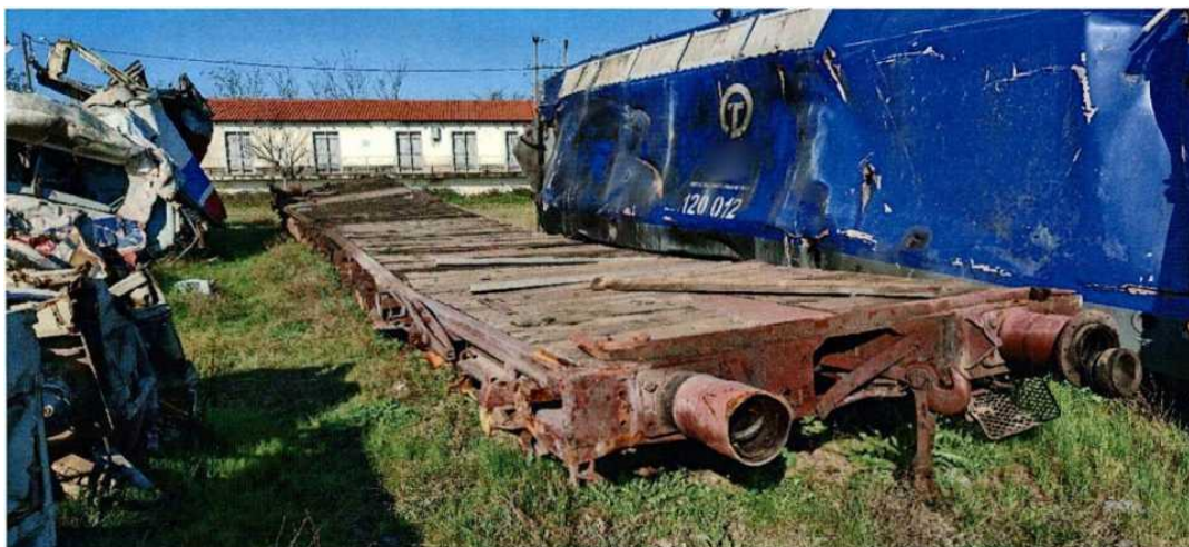
Εικόνα 81. Θέση 5) πλατφόρμα no 3 που φέρει χαλύβδινες πλάκες, με χαμένα τα φορεία από τον εκτροχιασμό, ελαφρά ζημιά (στρέψη) λόγω σύγκρουσης από το πίσω μέρος.
