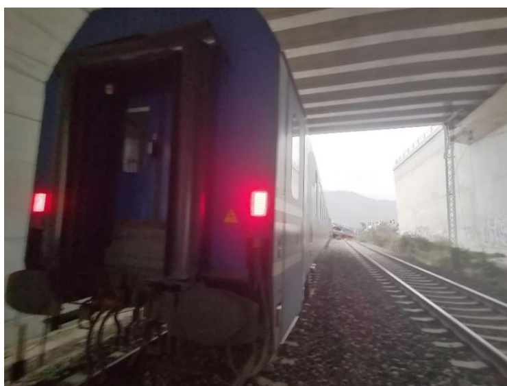
Εικόνα 89. Θέσεις 6-9) Βαγόνια B4-B7, B4 και B5 εκτροχιάστηκαν και χτυπήθηκαν στο πλάι από χαλύβδινες πλάκες, B6 και B7 δεν εκτροχιάστηκαν, καμία ζημιά, το B7 παρέμεινε σχεδόν όλο στη σήραγγα.
