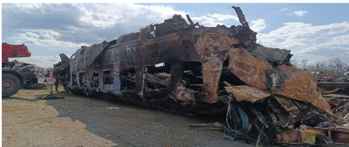
Εικόνα 87. Θέση 4) Β2 βαγόνι 2ης θέσης, μεγάλη ζημιά πρόσκρουσης εμπρός και πίσω, η φωτιά το κατέκαψε σιγά σιγά.
