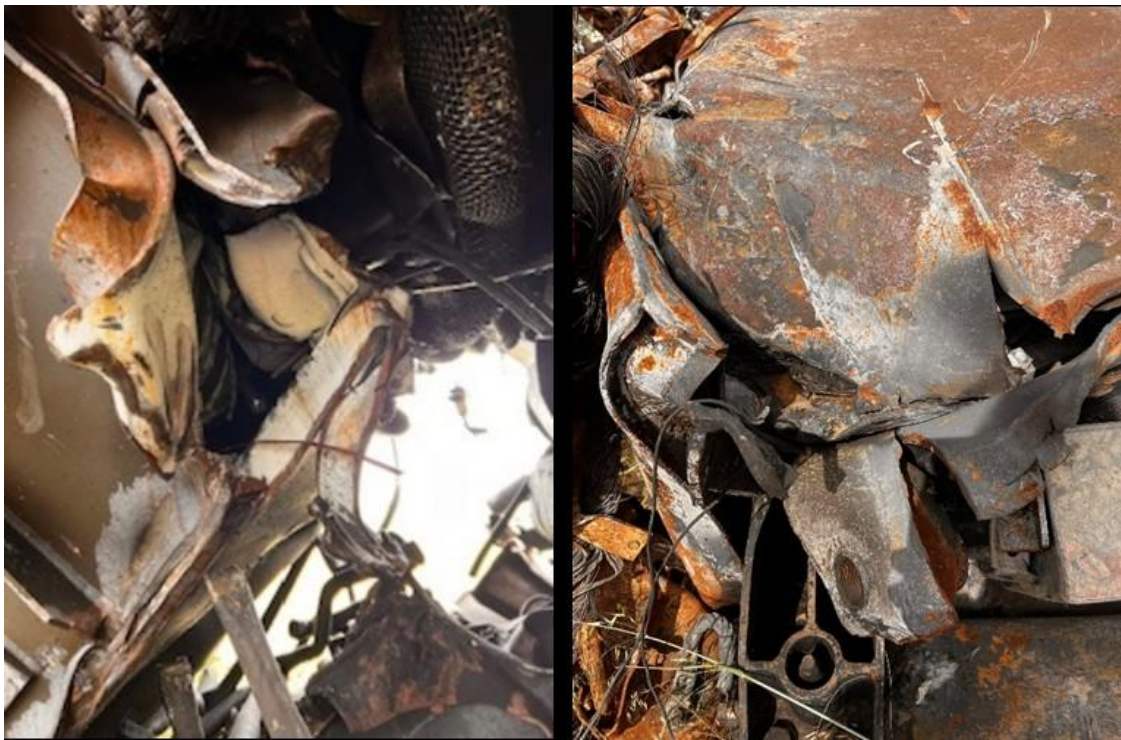
Εικόνα 67. Μεγάλες ρωγμές του μετασχηματιστή, ακόμα προσαρτημένος κάτω από την ηλεκτράμαξα 120-022 (Αριστερά).
