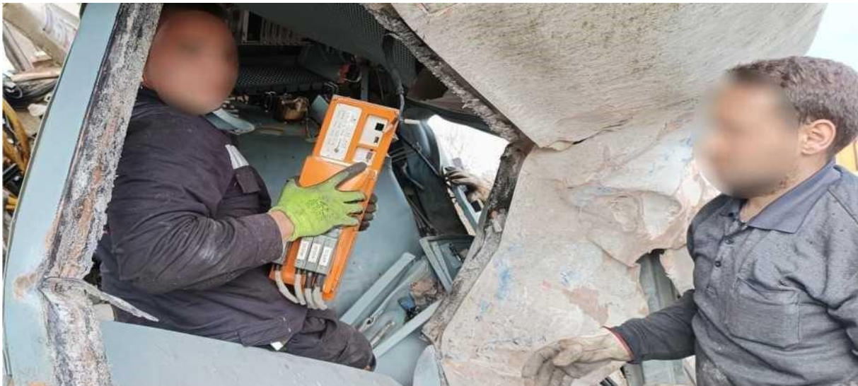
Εικόνα 54. Ο καταγραφέας δεδομένων TELOC, του συρμού 63503, ηλεκτράμαξα 120-022, ο οποίος ανακτήθηκε από δικαστικούς πραγματογνώμονες την 05/03/2023.
