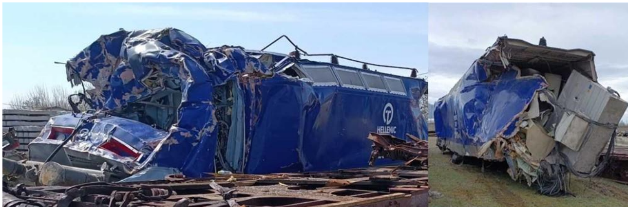
Εικόνα 78. Θέση 2) ηλεκτράμαξα 120 012, μεγάλη ζημιά μπροστά (με την ηλεκτράμαξα 120-022) και πίσω, σημάδια σύγκρουσης στο 1ο κοντέινερ στο P4, χωρίς την πίσω καμπίνα η οποία λείπει.
