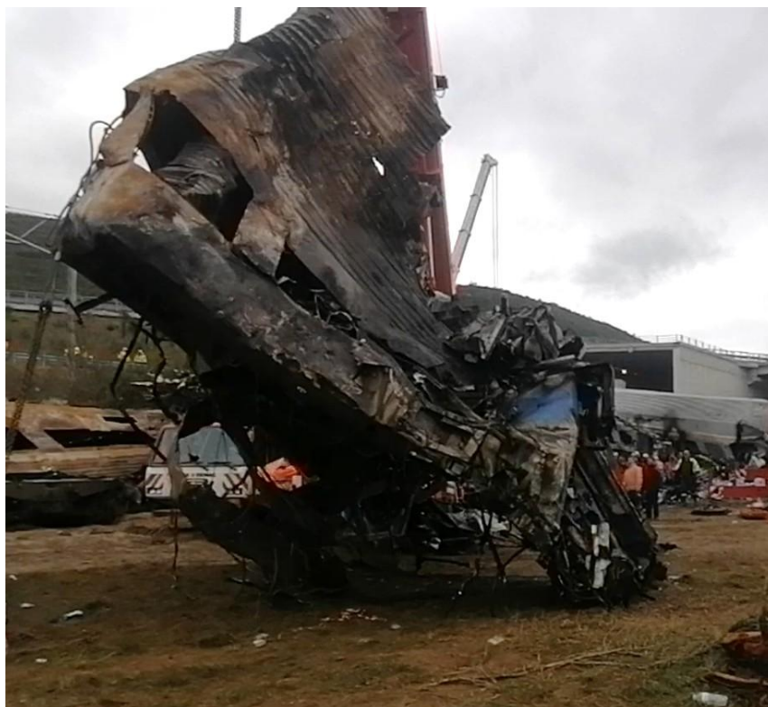
Εικόνα 86. Θέση 3) Βαγόνι εστιατορίου, με μεγάλη ζημιά από την αρχική σύγκρουση (διπλωμένο, λυγισμένο σε σχήμα S) και πλήρως καμένο. Εδώ, αναρτημένο από τα καλώδια του γερανού.
