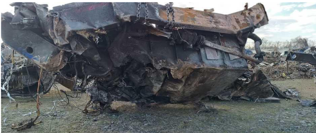
Εικόνα 85. Θέση 1) Ηλεκτράμαξα 120 023, ολοσχερώς κατεστραμμένη, σπασμένη σε μεγάλα κομμάτια. Υπολειπόμενο κομμάτι της βάσης της πλατφόρμας. Μέρος του μετασηματιστή ακόμα ορατό. Η άλλη πλευρά στο σχήμα 17. Στη θέση 2) το βαγόνι Α1 1ης κατηγορίας, ολοσχερώς κατεστραμμένο, έσπασε σε μικρά τμήματα και δεν ήταν αναγνωρίσιμο ως ολόκληρο όχημα.
